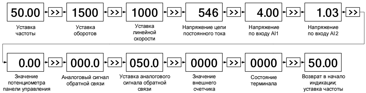
Рисунок 48 – Алгоритм просмотра текущих параметров ПЧ
